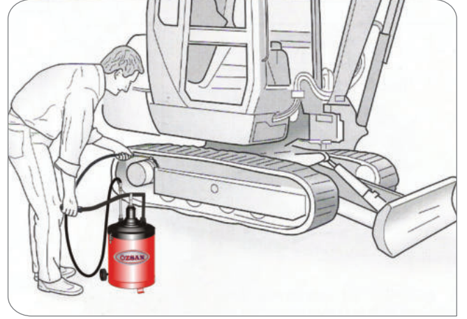
C-1 > 5 Kg Mekanik Gres Pompası (Basmalı)
