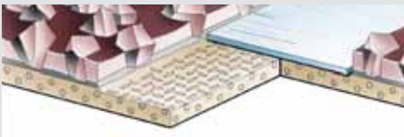
Toz tarafında özel folyolu, katlanmış bağlantı
